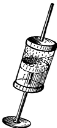
Рис. 2. – Шприц для определения концентрации CO 2
